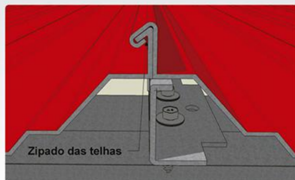
Zipado das telhas
