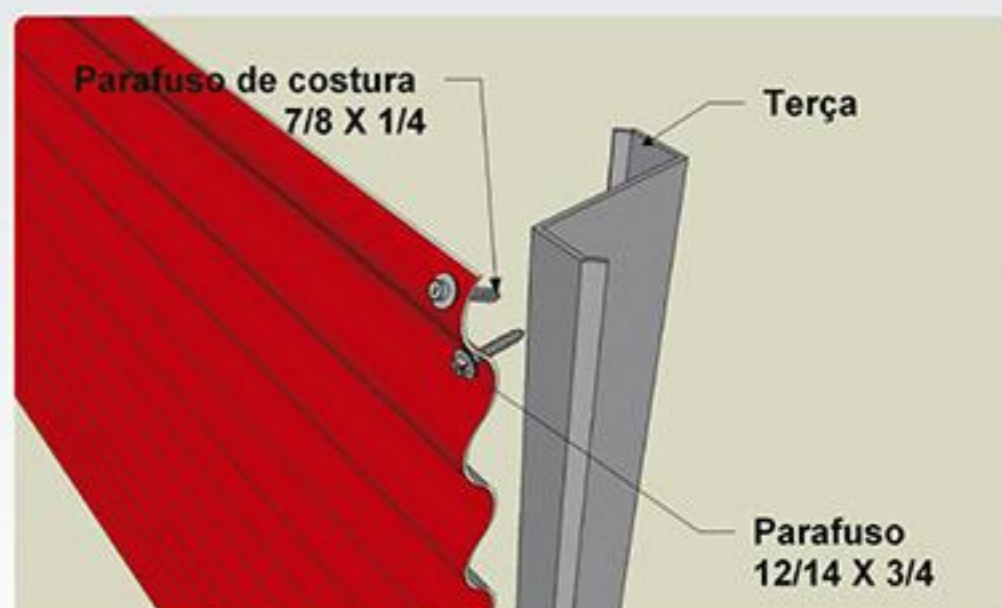
Detalhe de fixação de fechamento lateral
